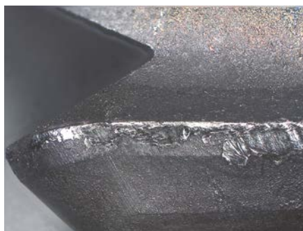
État de l'arête après d'usinage
